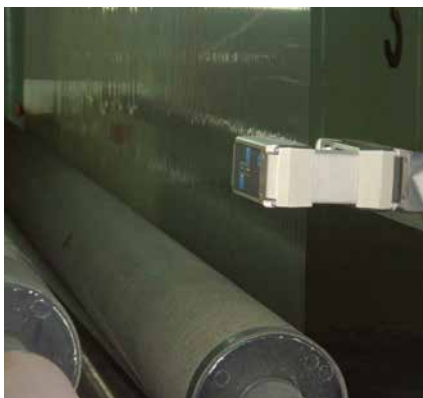
Sensor de borda ultrassônico FX 5 no sistema de produção de películas/filmes.
