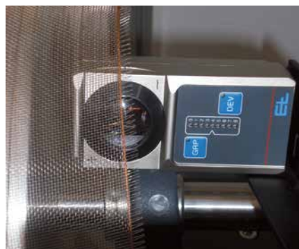
Sensor de borda infravermelho FR 52 para a detecção do tecido de malha
