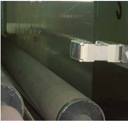
포일 생산 시스템에 사용된 초음파 에지 센서 FX 5
