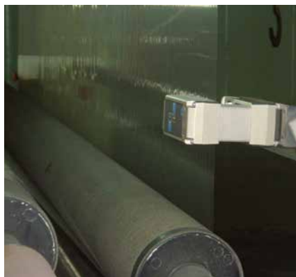
Sensor de borde por ultrasonido FX 5 en instalacion de producción de películas
