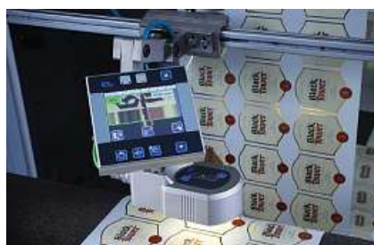
Sensor de linhas a cores FE 52 na máquina de inspeção de bobinação
