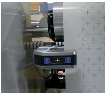
Sensor de borda ultrassônico FX 46 em borda de papel
