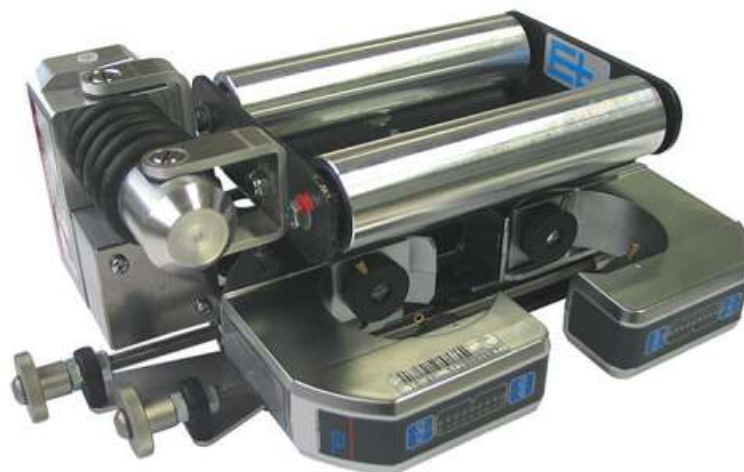
ELGUIDER DRS07 com sensor de borda infravermelho FR 46
