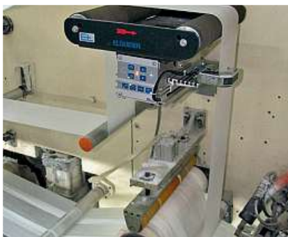
ELGUIDER DRS10 na máquina de fraldas
