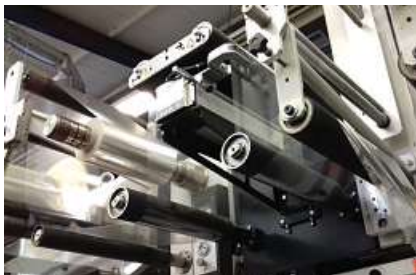
包装機械で使用する ELGUIDER DRB14
