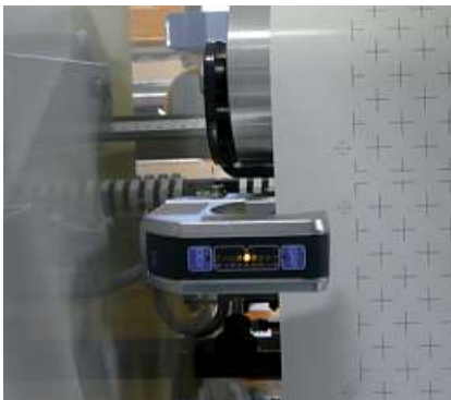
ペーパーエッジでの超音波エッジセンサ FX 46
