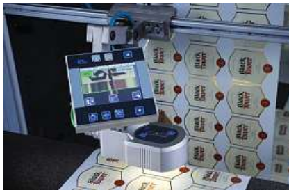
Sensore per linee colorate FE 52 su macchina di ispezione della ribobinatura
