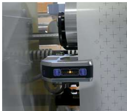
Sensore per bordi ad ultrasuoni FX 46 su bordo di carta
