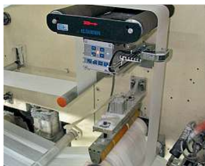
ELGUIDER DRS 10 in macchina per pannolini
