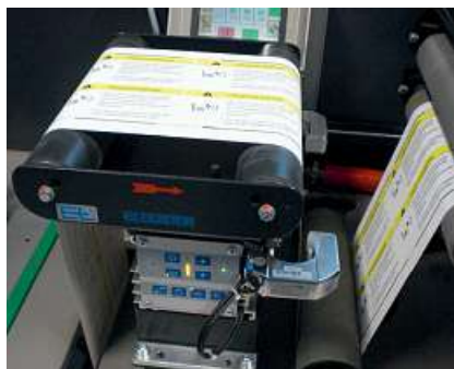
ELGUIDER DRS20 in macchina per stampa digitale
