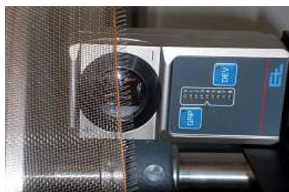
Sensore per bordi a infrarosso FR 52 per il rilevamento di tessuti a rete
