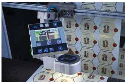
Capteur de lignes de couleur FE 52 sur une machine d'inspection pour bobineuse-débobineuse
