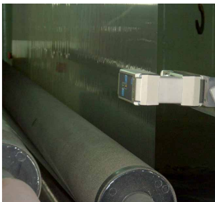
Ultraschall-Kantensensor FX 5 in Folienproduktionsanlage
