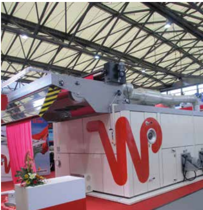
Segmentregelwalzenanlage SWA9501 am Auslauf Tumbler
