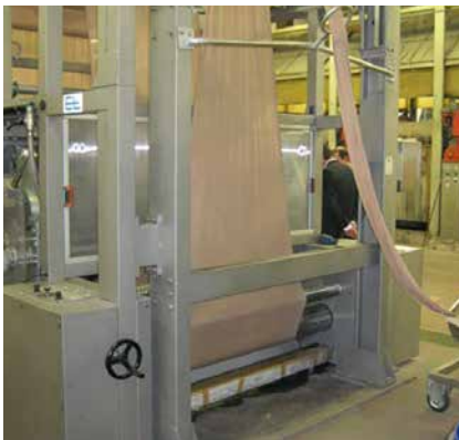
Segmentregelwalzensystem SWS96 an Strangaufdrehanlage
