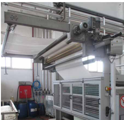
Segmentregelwalzensystem SWS9611 vor Foulard
