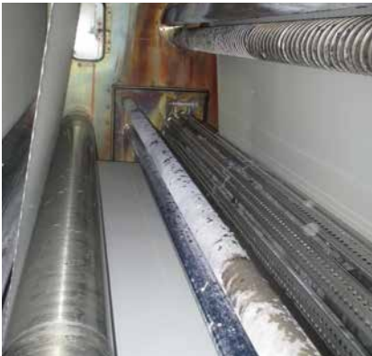
Segmentregelwalzensystem SWS97 im Bleichdämpfer
