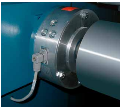
Flanschkraftaufnehmer PD 25 am Einlauf Schlichtetrog
