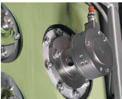
Flanschkraftaufnehmer PD 23 an Waschmaschine
