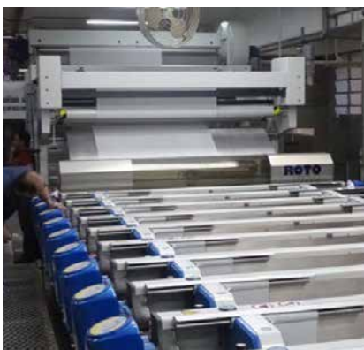
Segmentregelwalzensystem SWS95 am Einlauf Rotationsdruckmaschine
