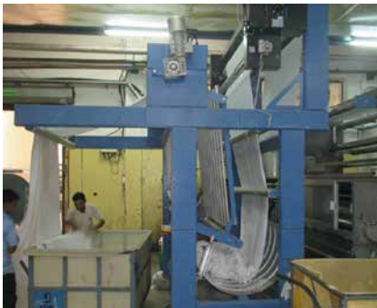
Segmentregelwalzenanlage SWA9511 nach Mulde vor Spannmaschine
