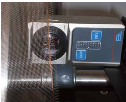
Infrarot-Kantensensor FR 52 für Gittergewebeerfassung
