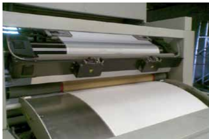
轮转印刷机进口口上的分段控制辊系统 SWS94
