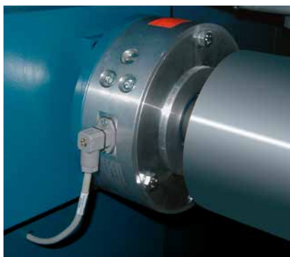
浆纱槽进口口处的法兰式张力测量器 PD 25
