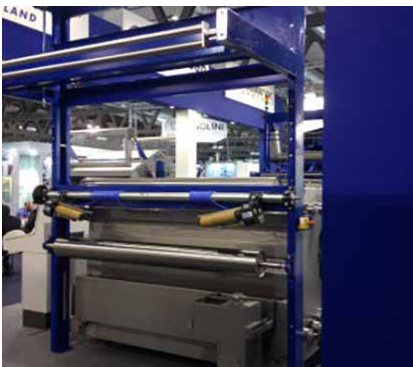
纺织品进料口中的织物幅面导正器 KF 2020
