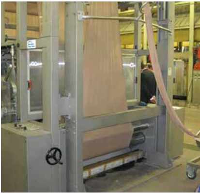
剖布解捻机上的分段控制辊系统 SWS96
