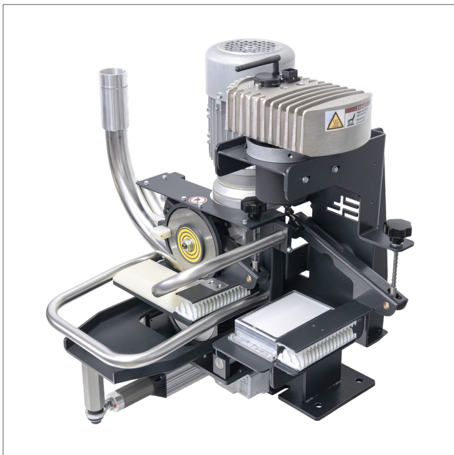
应用示例：使用 BT 8xxx 切割装置进行切刀跟踪
