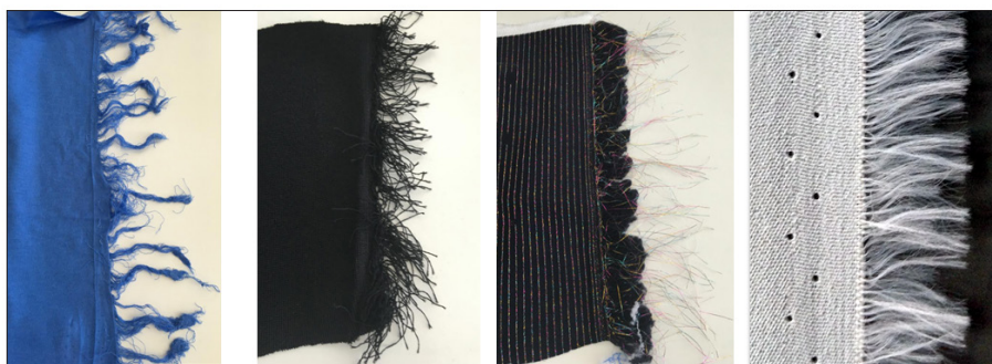
Fils de trame dépassant (exemples)
