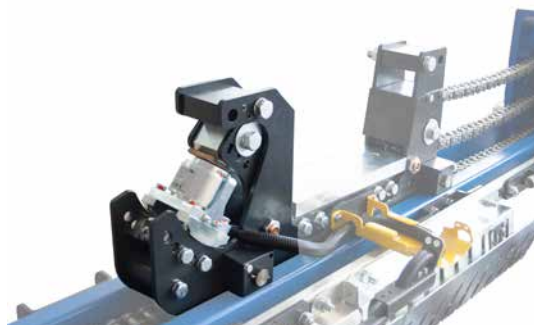
Sensor de tensión de cinta EM 10 en el carro tensor
