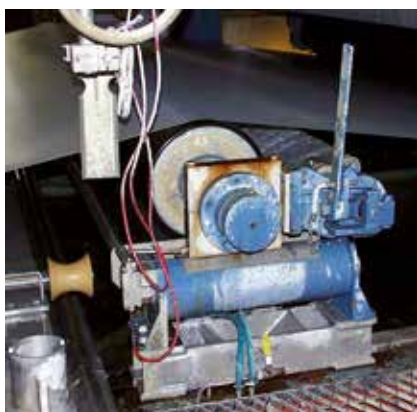
Sensor electromecánico de borde SH 8902 U (placa cerámica opcional) con soporte para sensor ST 7005
