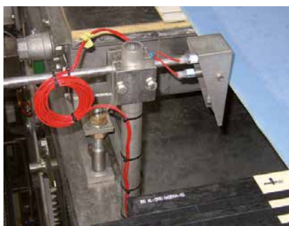
Alarmsensor FE 0722 U mit Sensorständer ST 7009
