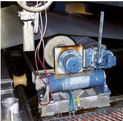
Elektromechanischer Kantensensor SH 8902 U (Keramikplatte optional) mit Sensorständer ST 7005
