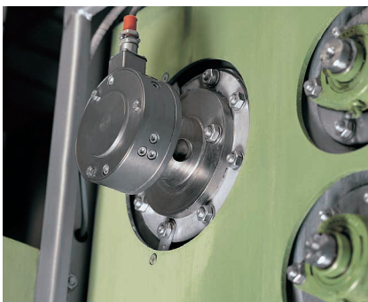
Flanschkraftaufnehmer PD 23 an Waschmaschine
