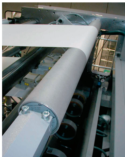
Sensorwalze PD 30 an Rollenoffsetdruckmaschine
