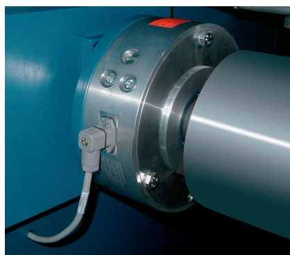
Flanschkraftaufnehmer PD 25 am Einlauf Schlichtetrog
